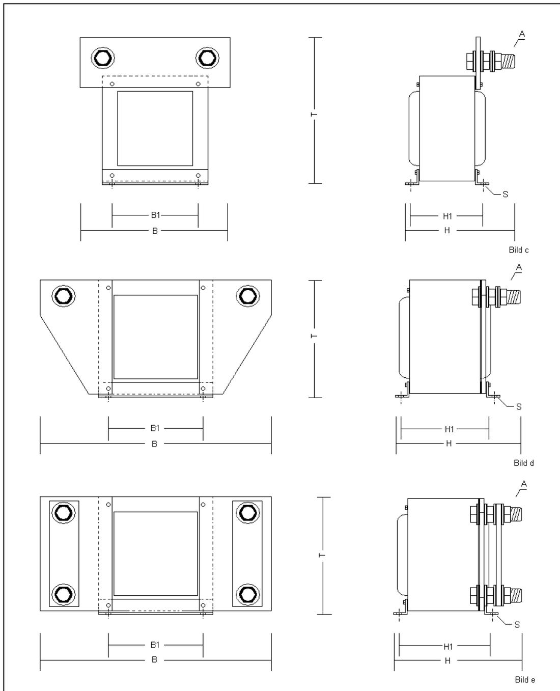
Ausführung: Schutzart IP00, Temperaturklasse : T40E, Typenreihe 16 bis 19b mit lose beiliegende Hilfskondensatoren im ALU – Rundbecher
