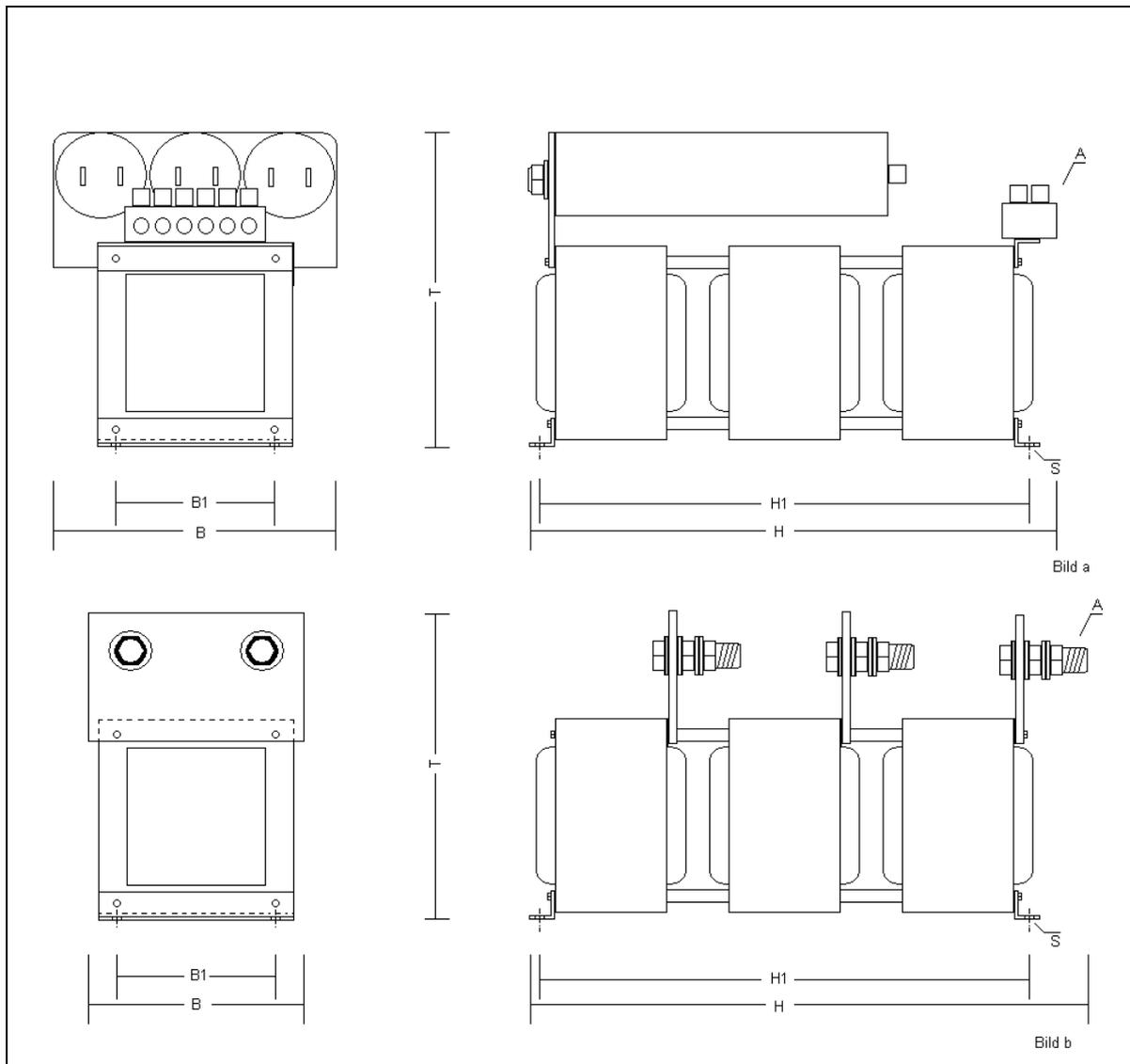
Ausführung: Schutzart IP00, Temperaturklasse : T40E, Typ 13 bis 15 mit lose beiliegende Hilfskondensatoren im ALU - Rundbecher
